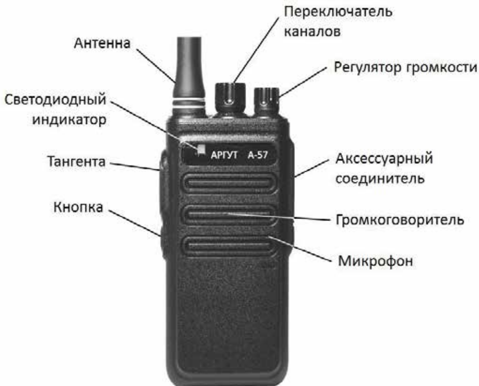
Рис. 1. Расположение органов управления, индикации и соединителей.
